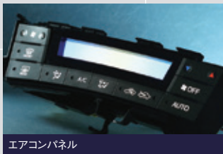
エアコンパネル
