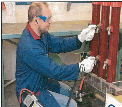
プローブをホールド/ケルピンクランプをCBIに取り付け、トリグ/テストボタンを押します。
